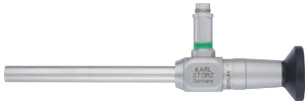
20916025AA **Optique VITOM® HOPKINS® à vision directe de 0°**, avec illuminateur intégré, distance de travail 25 – 75 cm, longueur 11 cm, **autoclavable**, avec conduction de la lumière par fibre optique incorporée, code couleur : vert
